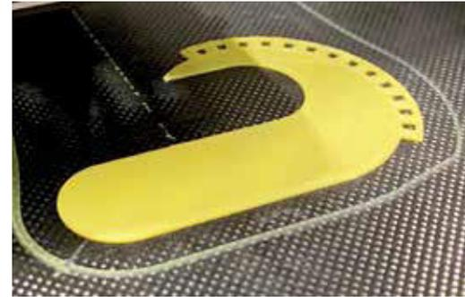
Ein Prototyp entsteht im 3D-Drucker
